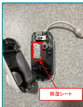
③内部の除湿シートを交換する ※必ず交換してください
