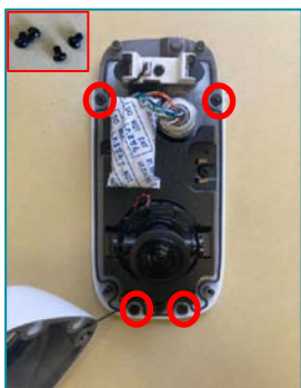
⑧カメラをマウントプレートに固定 ※付属のM3x3.6mmビスで○印4点
