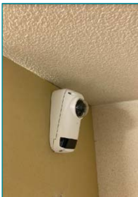
※TILTプレート使用時はカメラの上下を入れ替えても取付可能です。
