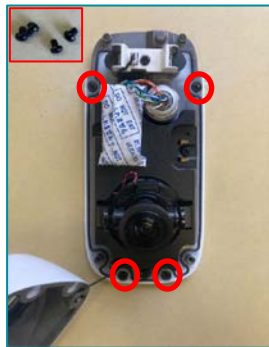
⑧画角を調整する ※+ドライバーでレンズの左右にある調整ネジを緩める
