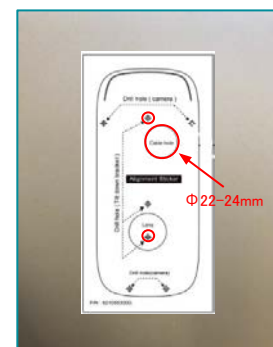
⑤墨出しシートを用いて通線口1箇所とアンカーの下穴2箇所を空ける ※ビスのみで固定する場合は下穴不要
