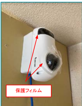
⑩完了 ※レンズカバーとIED照射部のフィルムを剥がしてください。
