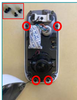
⑦カメラをマウントプレートに固定 ※付属のM3x3.6mmビスで○印4点
