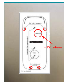
⑤墨出しシートを用いて通線口1箇所とアンカーの下穴4箇所を開ける
