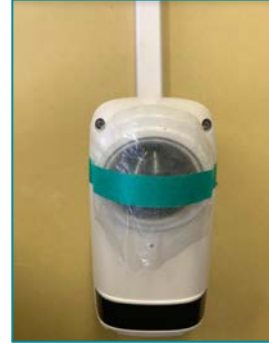
④カバーを取付 ※トルクドライバーを用いて締める
