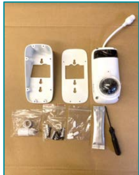
①付属品の確認 ビスセットx1,除湿材x1,防水コネクタx1カメラ本体x1,ゴムキャップx1,T10ドライバーx1
