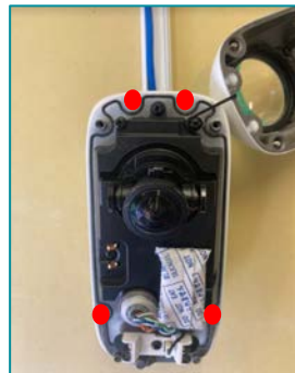
③カメラをTILTプレートに固定し、画角調整する ※●印4箇所
