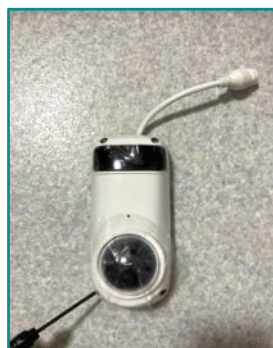
②カバーを外す 付属のT10レンチで3か所のビスを緩める。
