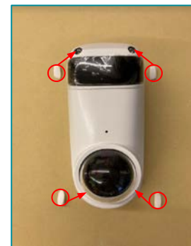
⑨カバーを閉じ、ゴムキャップを取り付ける。 ※カバーを閉じる際はゴムパッキンを挟まないように注意 ※カバーを閉じる際はトルクドライバーを用いてビスを閉める
