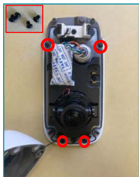
⑦カメラをビスで固定する ※※付属のM3x3.6mmビスで○印4点
