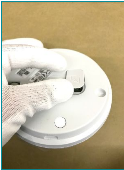
①カメラ背面のSDカードスロットの蓋を開けてSDカードを挿入する
