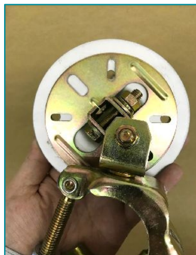
②フィクサーと単管クランプを重ねる
