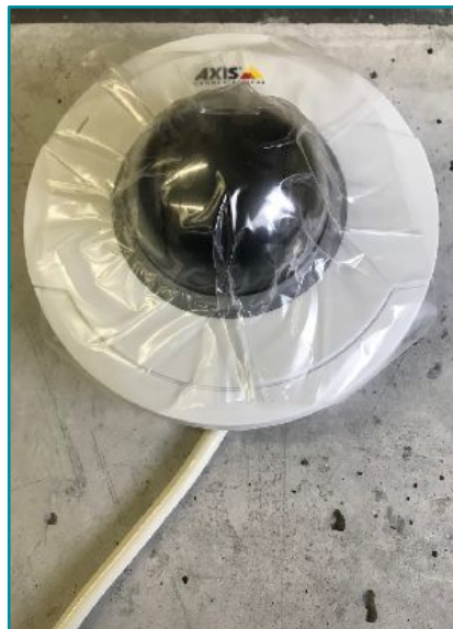
⑤カメラを取付金物に固定して完了 ※フィルムを剥がして画像を確認しながら 画角を調整してください。
