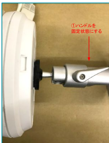
※カメラを固定後はハンドルを固定状態にする
