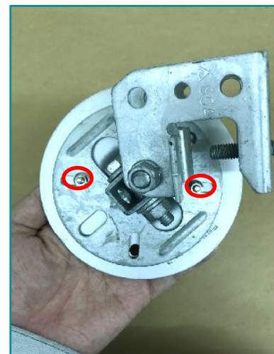
③フィクサーとビームラックをビスで固定する ※○印2か所
