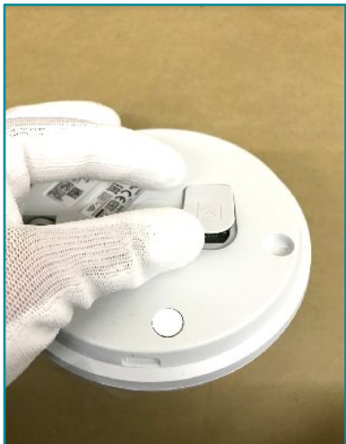
①カメラ背面のSDカードスロットの蓋を開けてSDカードを挿入する
