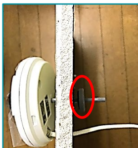
※○印の円盤状の留め具を先に棒に通してください。 ※棒をカメラのネジ穴に固定後に留め具を締めてください。
