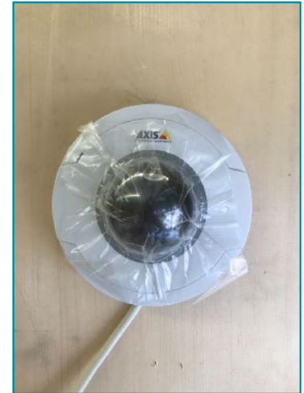
③カメラを取付金物に固定し画角を調整して完了 ※設置後は保護フィルムを剥がしてください ※画角調整は画像を確認しながら実施してください。
