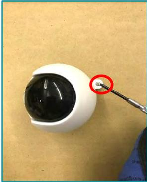
①カメラ本体と取付板を固定しているビスを#1プラスドライバーを用いて外す
