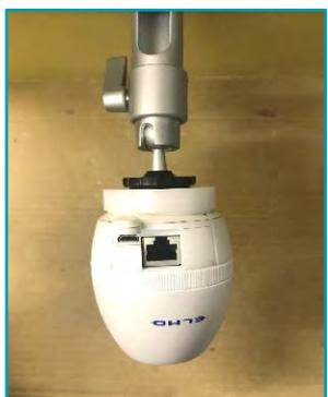
⑨カメラをフィクサーに固定し、LANケーブルを接続する
