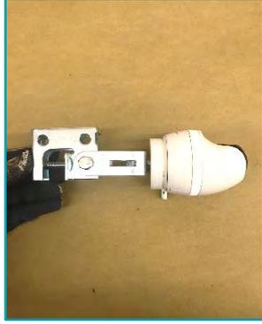
⑥H鋼固定金具にカメラを取り付ける
