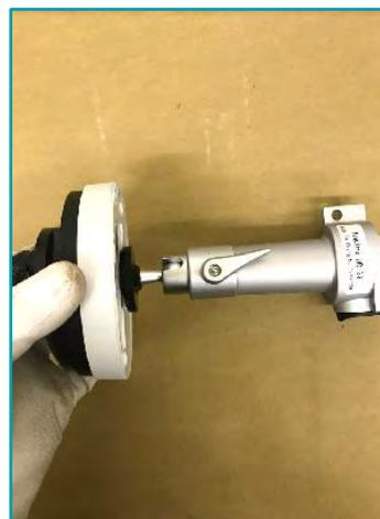
・コンジットバックボックス裏側の4/1インチ穴にDR-31を取付ける
