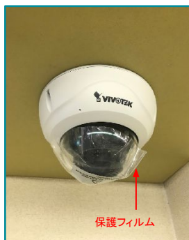
⑪完了 ※設置後はカバーの保護フィルムを剥がしてください。
