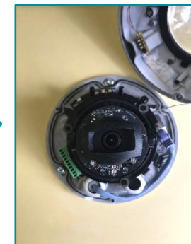
⑨LANケーブルをLANポートに接続する。 ※カチッと音がするまで差し込む
