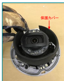
③カメラ本体の保護カバーを取り外す
