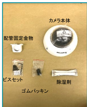
①付属品の確認 配管固定金物x1 ビスセットx1 予備ゴムパッキンx1 除湿剤x1 カメラ本体x1
