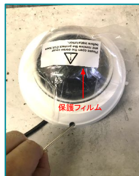
⑩完了 ※設置後はカバーの保護フィルムを剥がしてください。
