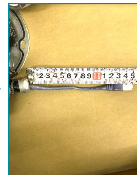
※カメラ内部のケーブル長は110mm~150mm
