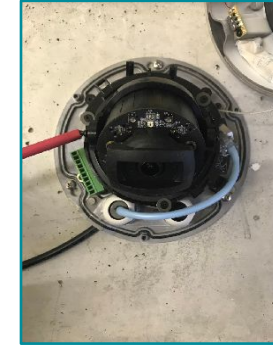
⑨画角を調整する ※レンズ両側の+ビスを緩めて画像を確認しながら画角を調整する。調整後はビスを締めて固定してください。
