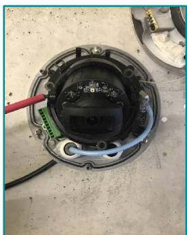
⑩画角を調整する ※レンズ両側の+ビスを緩めて画像を確認しながら画角を調整する。調整後はビスを締めて固定してください。
