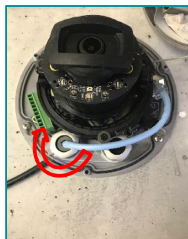
⑧LANケーブルをLANポートに接続し、カメラを固定する ※LANポートに接続後は予長を調整しゴムパッキンを締める
