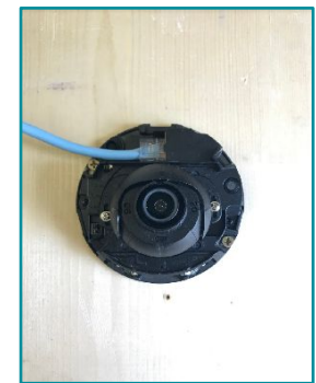
⑤LAN(UTP)ケーブルを接続する ※カチッと音がなるまで差し込む
