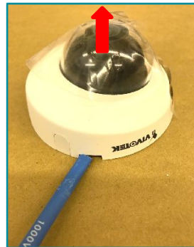
②カバーを外す ードライバーか爪を溝に入れてカバーを真上に強く引っ張る
