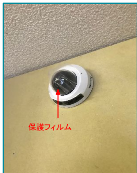
⑩完了 ※設置後はカバーの保護フィルムを剥がしてください。
