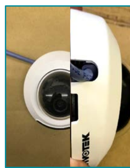
※壁付けした際に入線口が左上になります。LAN(UTP)ケーブルとカバーの間に隙間ができるため白色のエアコンパネ等で塞いでください。
