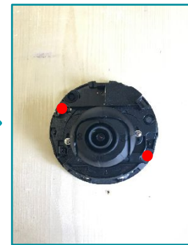
④設置面にカメラを固定する ※●印2か所固定
