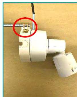
⑨吊りボルトにカメラを固定する
