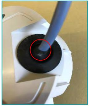
※防水性を確保するためにゴムブッシングの○印部分が外側に膨らむようにすること
