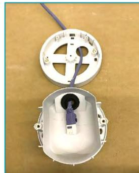
⑥LANケーブルをコンジットバックボックスとベースに通した後2つを固定する。
