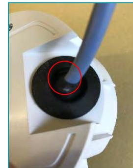
※防水性を確保するためにゴムブッシングの○印部分が外側に膨らむようにすること
