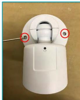
①付属のT10レンズを用い○印2か所のビスを緩め、カメラ本体をベースから取りはずす。
