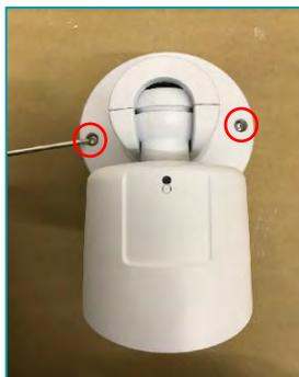
①付属のT10レンチを用い○印2か所のビスを緩め、カメラ本体をベースから取りはずす。
