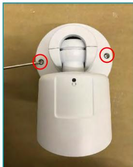
①付属のT10レンチを用い○印2か所のビスを緩め、カメラ本体をベースから取りはずす。
