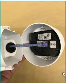
⑦LANケーブルをカメラ本体のLANポートに接続してカメラ本体とベースを閉じる
